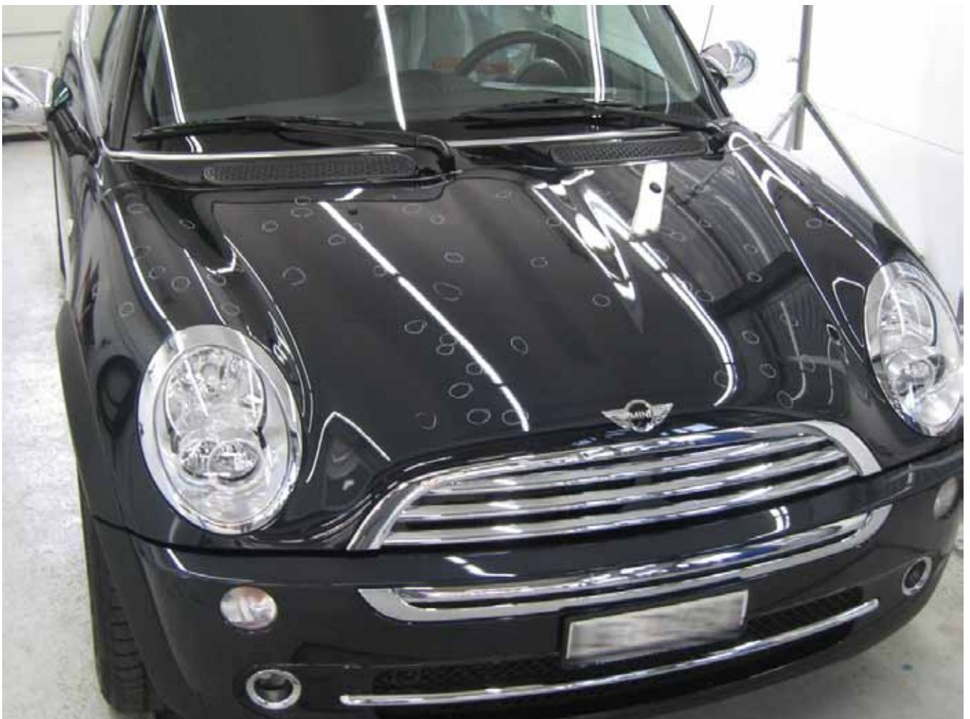
Beispiel eines mittleren Hagelschadens - Motorhaube wurde mittels Drücktechnik in Stand gesetzt.
