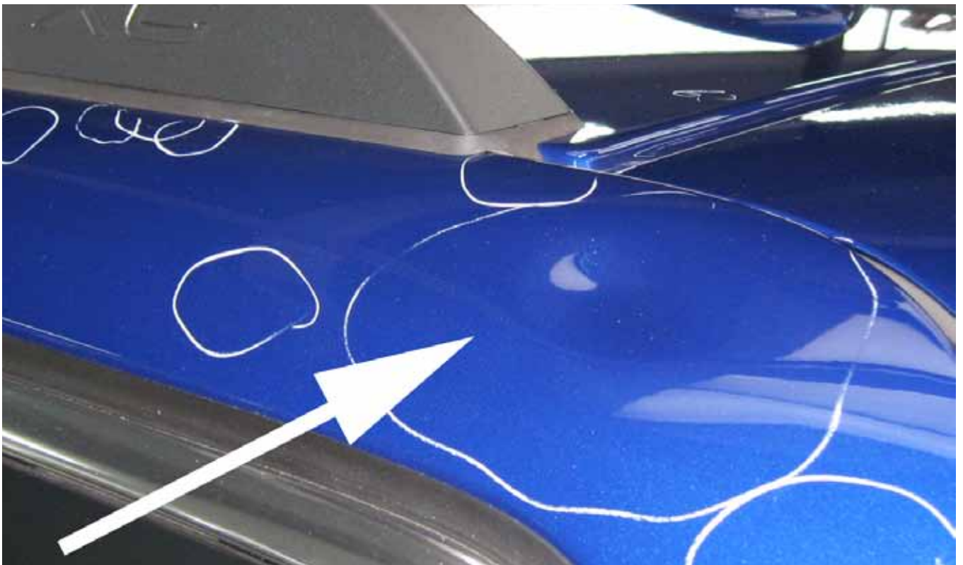
Ebenfalls massive Dellen im seitlichen Dachbereich
