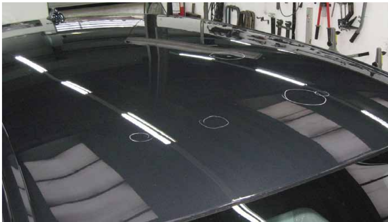
Auch auf dem Dach vereinzelt Dellen
