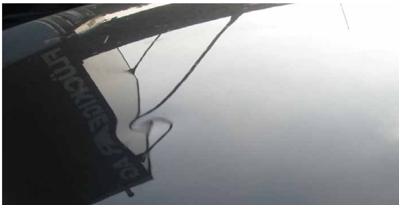
Detailaufnahme einer Delle
