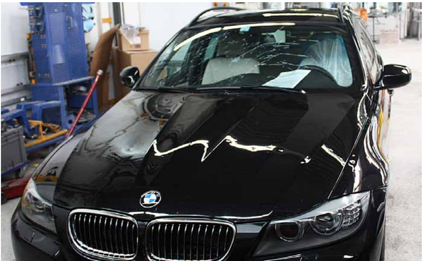
Aufgrund der massiven Beschädigung wurde hier die Dachaussehenhaut ersetzt.
